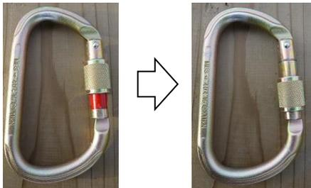
ロッキング部が閉じている状態で地面に対して下を向き、重力による緩みがないようにすることを「スクリューダウン」と言います。
